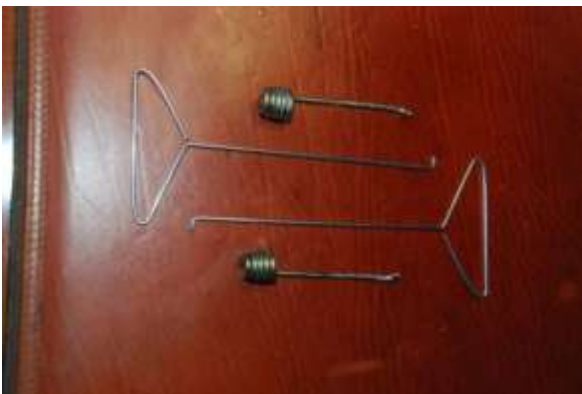
Le forchette di estrazione auto costruite, ma si trovano anche sul WEB
