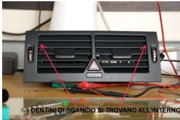
Dove individuare le linguette da alzare per le bocchette centrali e far leva per tirare
